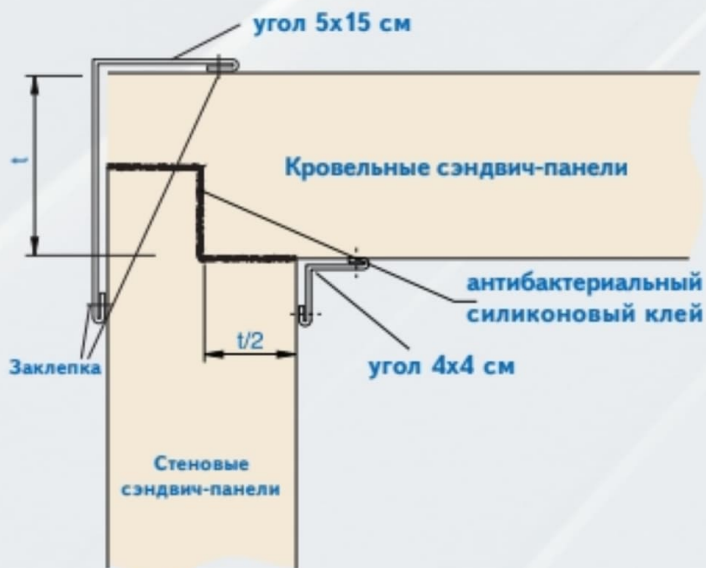
Срез площади закрепления потолка к стене
